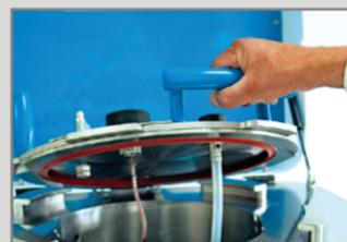
Limpieza rápida y eficiente: Diseño de tapa plana y manguera de limpieza integrada (opcional).
