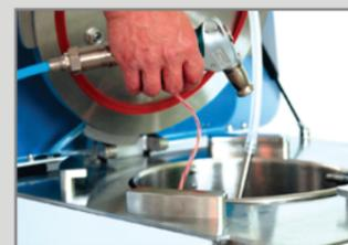
El primer preparador de medios automatizado con dispensador integrado: Conexión a bomba electrónica.
